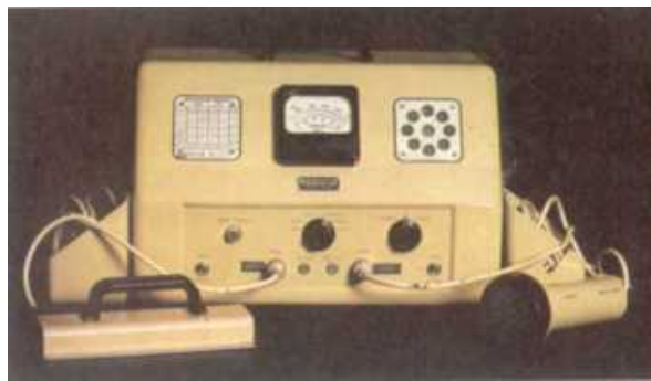
Contador Geiger portátil. Este tipo de aparatos permiten detectar y medir las radiaciones emitidas por los núcleos atómicos.
