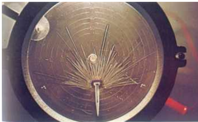
Cámara de Wilson en la que aparecen las trazas producidas por las partículas \alpha emitidas por una fuente radiactiva.
