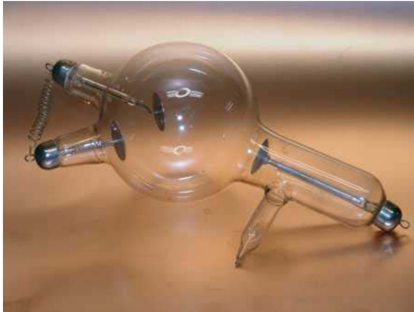
Válvula de rayos X. Los rayos X emitidos por la lámpara, al alcanzar las paredes de ésta, producen luz por fluorescencia.
