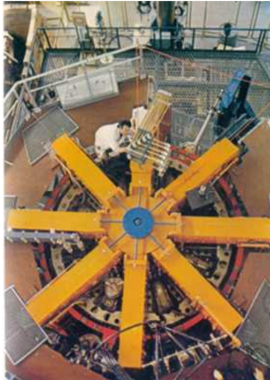
Vista superior del reactor termonuclear Tokomat, usado para el estudio de las reacciones de fusión en plasma.
